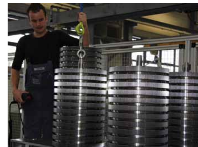
Im Bild Daniel Jöri (Leiter Verzahnerei) neben dem Fertig- und Rohteilspeicher. 120 Stunden können mannos gefertigt werden.
